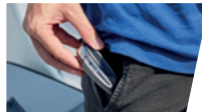
Wegfahrsperre. Die Zündung kann nur aktiviert oder deaktiviert werden, wenn sich der Schlüssel im Bereich von 80 cm zum Empfänger befindet.
